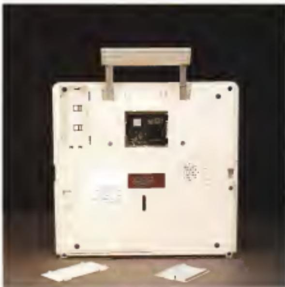
Il fondo del computer aperto sui sportelli di espansione. In alto il socket di clock (7 viti) e le RAM supplementari. Al centro lo zoccolo per il coprocessore 80285/5X.
